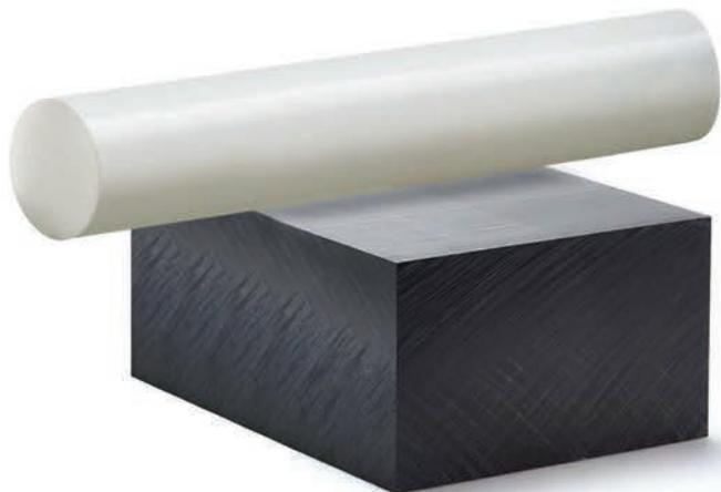
**ПОЛІАМІД** (капролон, ПА) виробництва компанії **GEHR GmbH** (Німеччина) відрізняється високою температурною стабільністю (робоча температура від - 40 ° С до + 100 ° С) і високою жорсткістю, твердістю і міцністю, що є його основними характеристиками. У зв'язку з тим, що гарні механічні характеристики досягаються тільки після провітрювання, матеріал повинен бути обов'язково провітрений після відпалу. На додаток, достатнє провітрювання досягається автоматично при тривалому зберіганні на повітрі.
